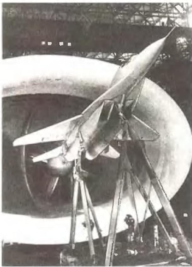
Рис.2. Легкий маневренный истребитель МиГ-29 в аэродинамической трубе
